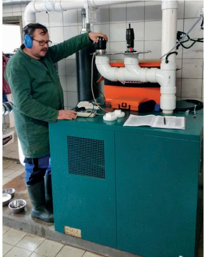
Herr Manske führt eine Messung der Vakuumpumpe bei 50 kpa durch.
