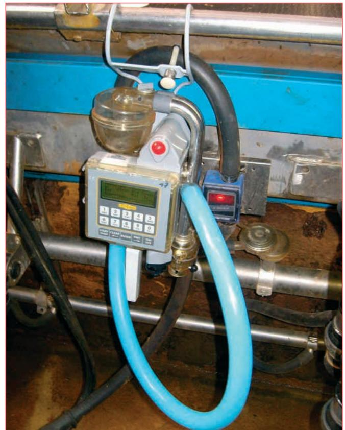
Im Jahr 2016 konnten in 6 Betrieben ca. 2.600 Lactocorder Messungen durchgeführt werden. Die aus den Analysen gewonnenen Erkenntnisse zur Einstellung der Melktechnik und vor allem zur Verbesserung der Melkroutine führen bei konsequenter Umsetzung zu einem flüssigen Arbeitsablauf und gesteigerten Durchsatz im Melkstand bei gleichzeitig geringer Belastung der Euter. Darüber hinaus
