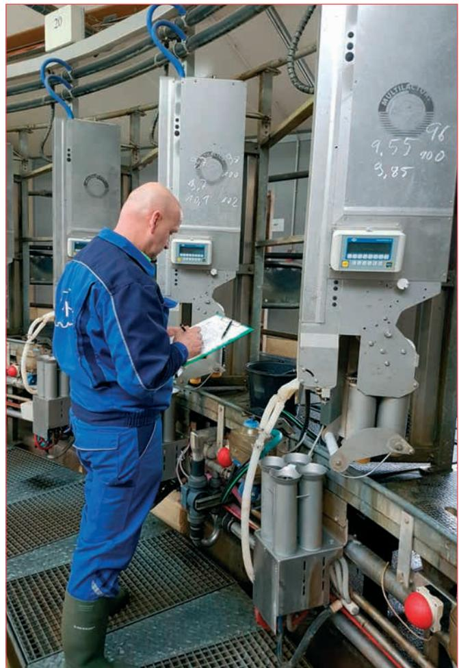
Jährliche Kontrolle melktechnischer Parameter nach standardisierten und vergleichbaren Kriterien (DIN ISO) als notwendige Funktionskontrolle.
